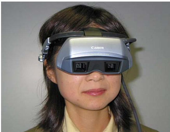
写真2 ビデオシースルー方式HMDの使用状態 (写真提供：キヤノン(株) 2010年10月)
